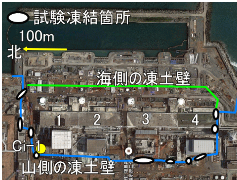
図一4 凍土壁の概要
