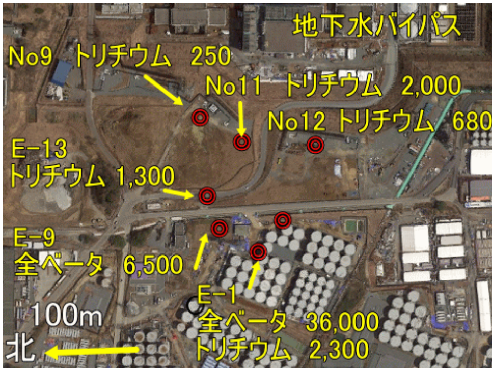
図一六 地下水バイパスと山側（上流井戸）の放射性物質濃度
