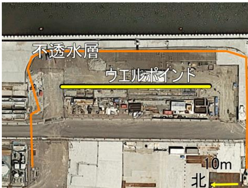
図一6 ウェルポイントと不透水層（2、3号機間）
