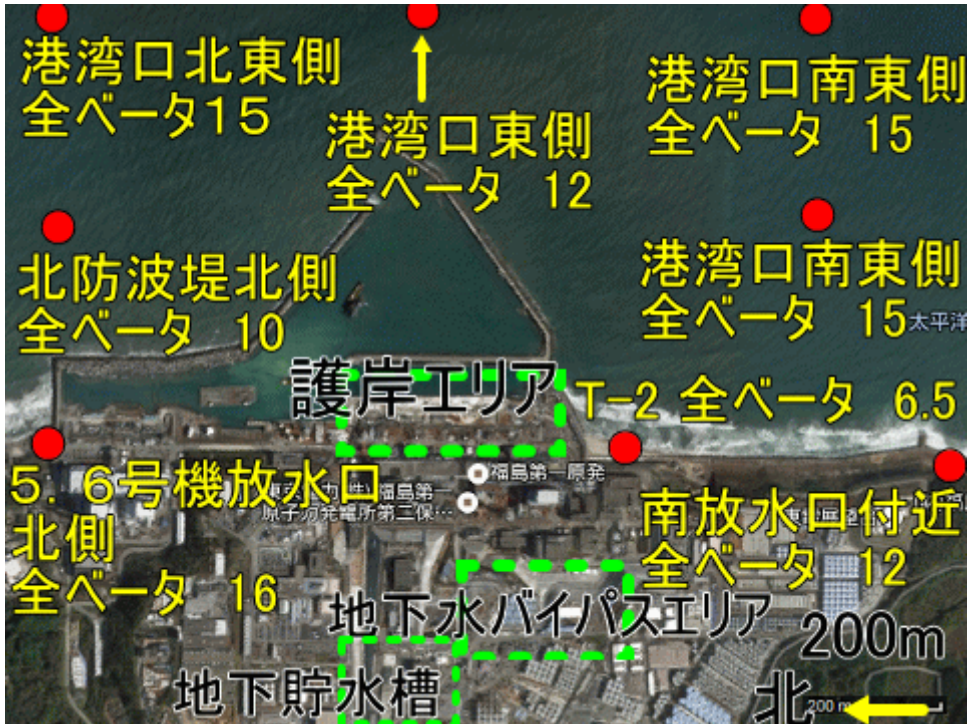
図一 1 福島第一原発および近傍外洋の放射性物質濃度
