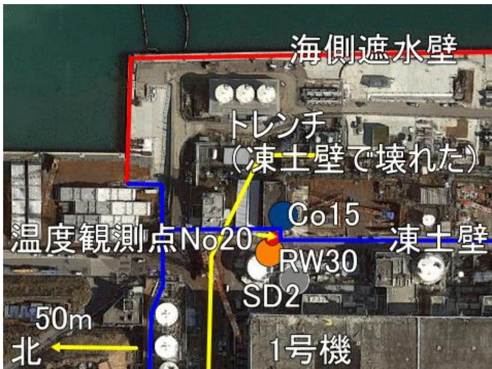
図-6 「海1-①」付近の水平配置
