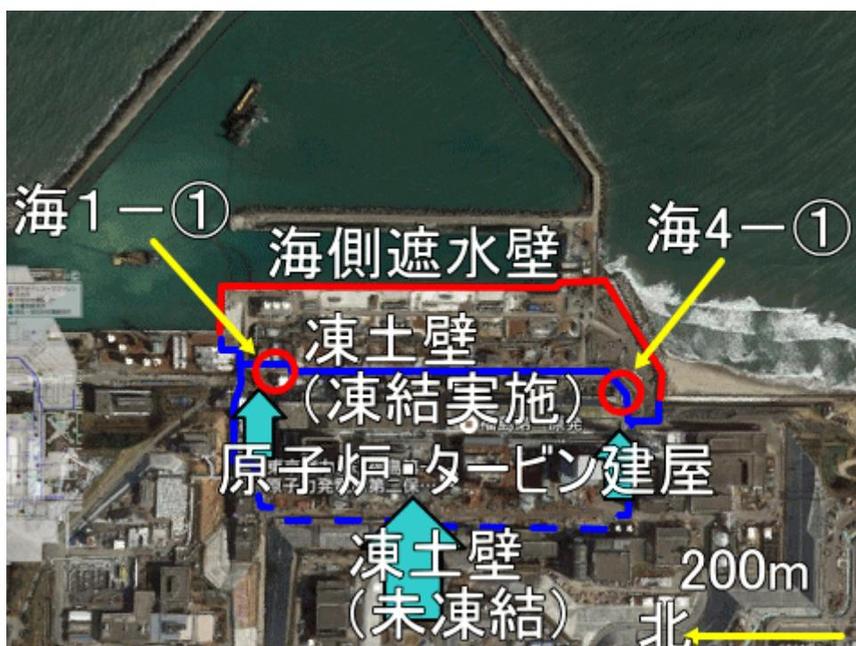
図-2 凍土壁と海側遮水壁の配置
