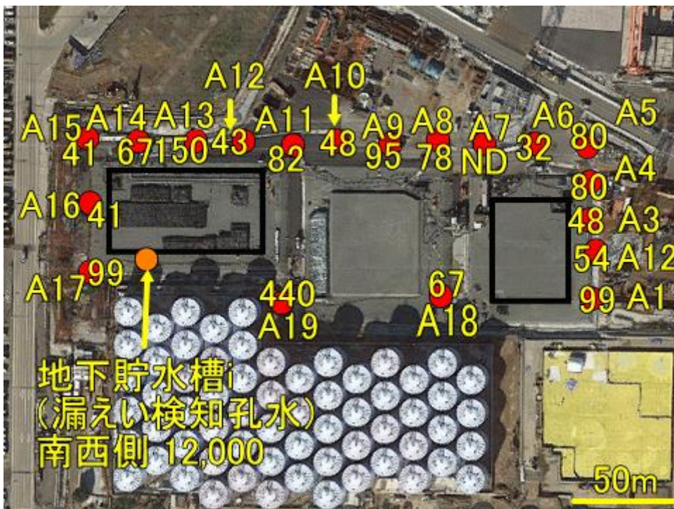
図-4 地下貯水槽周囲の全ベータ濃度
